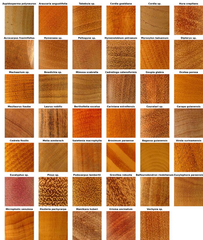
Fig. 2. Images of some wood classes (Filho et al., 2014)
